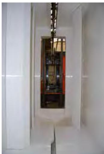
Les deux stations de poudrage manuelles et la zone de sortie sont équipées de portes battantes et permettent, lorsqu'elles sont fermées, de réduire les surfaces ouvertes dans la cabine et d'augmenter ainsi la vitesse de l'air, afin de réduire les sorties de poudre lors des opérations de nettoyage.
