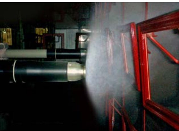
Bol tournant à haute vitesse de 5000 à 45000 tr./min en charge
