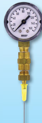
Mesure la pression d'air dans le tuyau de sablage
